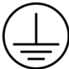
Figure 7 – Symbole IEC 60417-5019: Terre de protection
