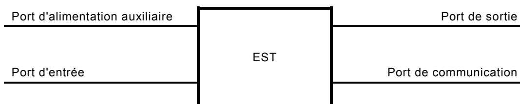
Figure 1 – Ports essayés dans la présente norme pour les relais de mesure et dispositifs de protection
