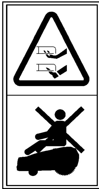
Figure EE.7 – Représentation du signal de sécurité – «MISE EN GARDE – Ne pas monter sur la machine»
