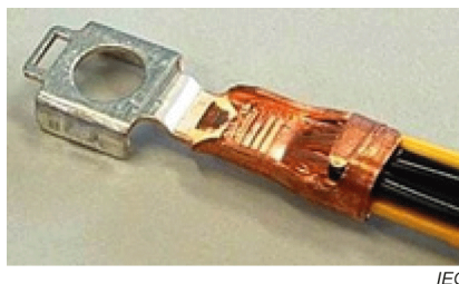
Figure 16 – Exemple de soudage de plusieurs fils sur une seule sortie
