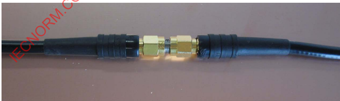
Figure 20 – Etalonnage de l'affaiblissement des fils coaxiaux
