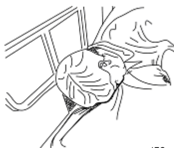
Figure AA.14 – Exemple de piégeage potentiel du PATIENT dans la zone C entre les BARRIERES LATERALES scindées
