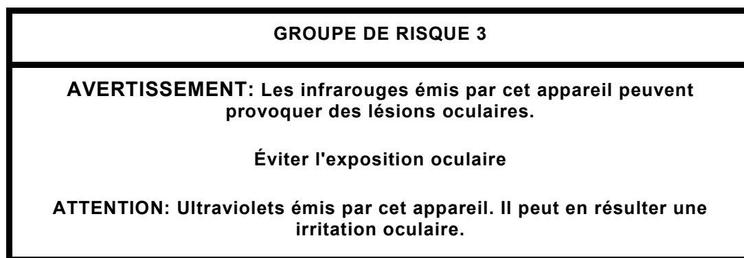
Figure 201.101 – Exemple d'étiquette explicative pour un appareil présentant plusieurs plages spectrales de danger
