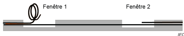
Figure 37 – Concept de l'accès à mi-portée rectiligne
