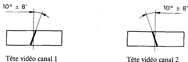
FIG. 18. – Angle azimut des têtes vidéo (en regardant l'entrefer).
