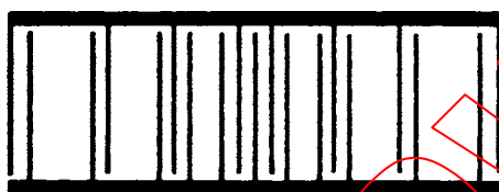
Figure 7 – Pondération par suppression obtenue par suppression sélective des doigts
