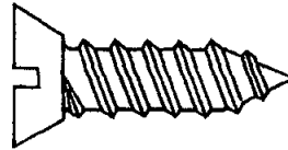
FIG 1 — Vis autotaraudeuse par déformation Thread-forming tapping screw
