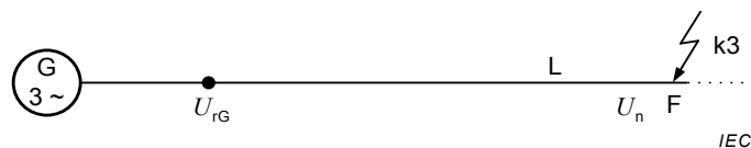
Figure 8b – Court-circuit alimenté depuis un alternateur
