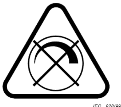
Figure 1 – Utilisation avec un gradateur interdite
