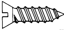
Figure 1 – Vis autotaraudeuse par déformation de matière (3.6.10)
