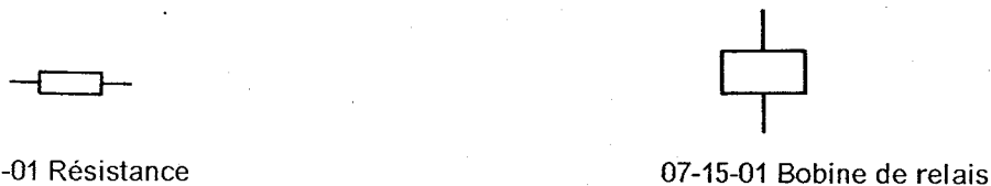
Figure 55 - Exemple de symboles où l'emplacement des connexions change la signification.
