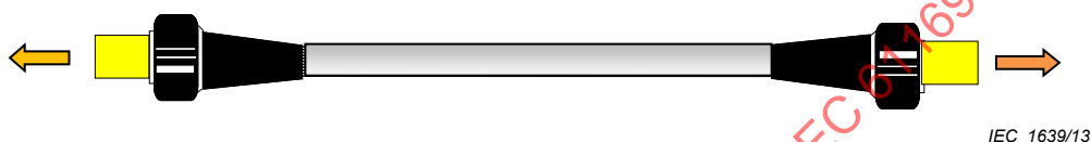
Figure 9 – Configuration d'essai de traction
