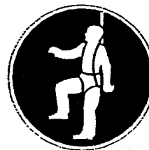
Protection obligatoire individuelle contre les chutes
