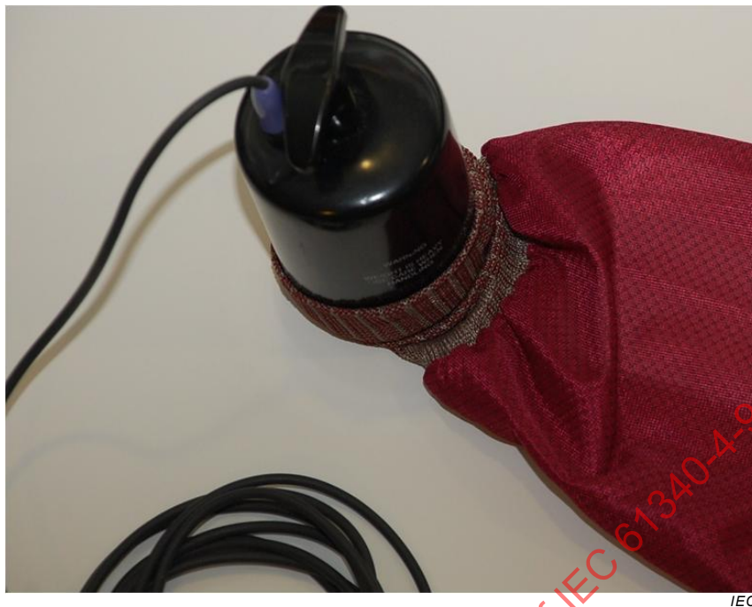
Figure 5 – Montage d'essai – Résistance point à point (électrode insérée dans un bord-côte)
