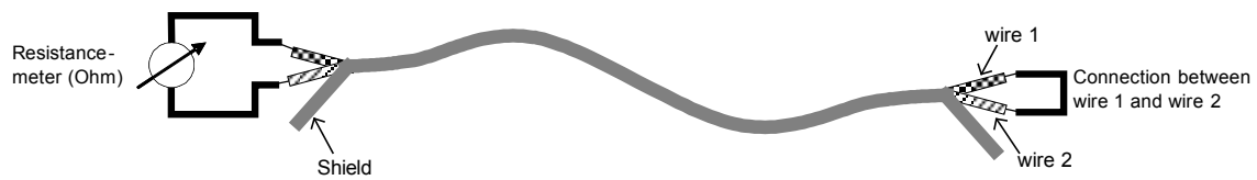
Figure N.1 – Loop resistance measurement wire to wire
