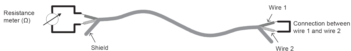
Figure N.1 – Loop resistance measurement wire to wire
