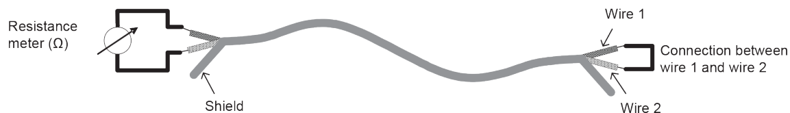
Figure N.1 – Loop resistance measurement wire to wire
