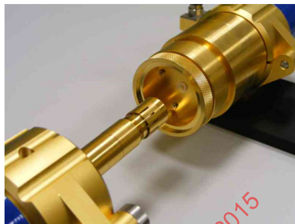
Figure A.7b – Rétention d'essai montée
