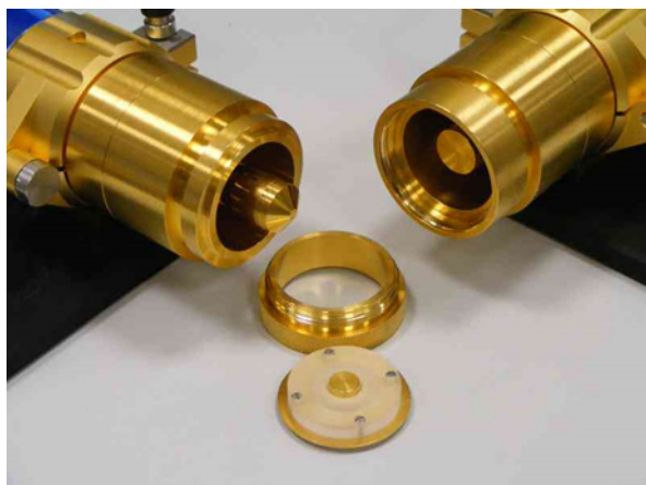
Figure A.7a – Rétention d'essai démontée
