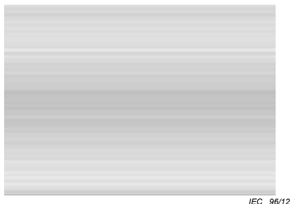
Figure 10 – Echantillon d'image d'un défaut de mura de ligne associé à une non uniformité TFT
