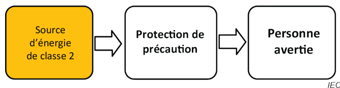
Figure 14 – Modèle pour protéger une personne avertie contre une source d'énergie de classe 2
