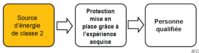
Figure 17 – Modèle pour protéger une personne qualifiée contre une source d'énergie de classe 2
