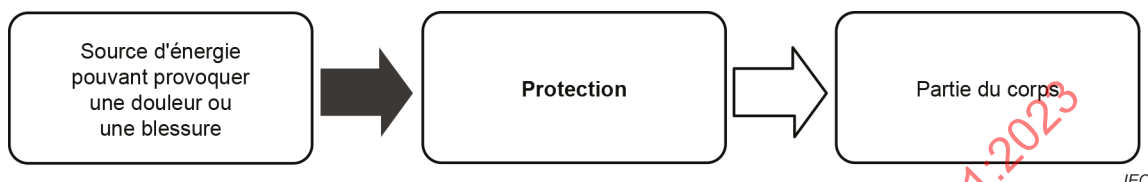
Figure 2 – Modèle en trois blocs pour la sécurité
