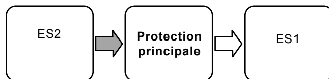
Figure 26 – Modèle pour protéger ES1 contre ES2
