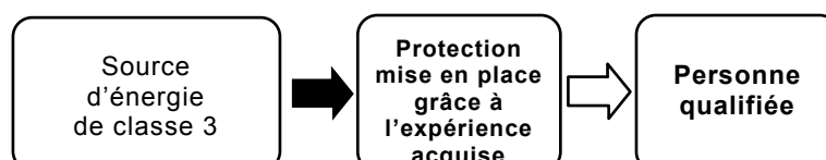
Figure 18 – Modèle pour protéger une personne qualifiée contre une source d'énergie de classe 3
