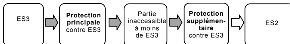
Figure 30 – Modèle pour protéger ES2 contre ES3
