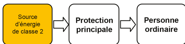
Figure 10 – Modèle de protection d'une personne ordinaire contre une source d'énergie de classe 2
