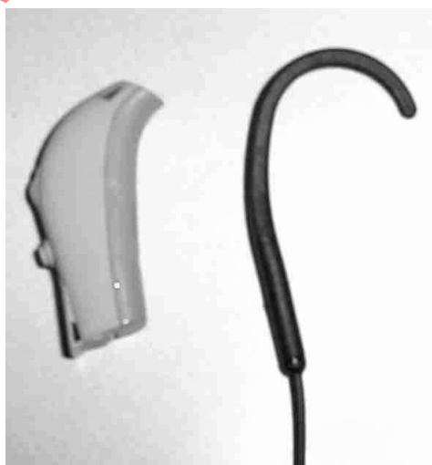
Figure 1 – Un transducteur d'induction auriculaire, avec un corps d'appareil de correction auditive contour d'oreille pour fournir une échelle
