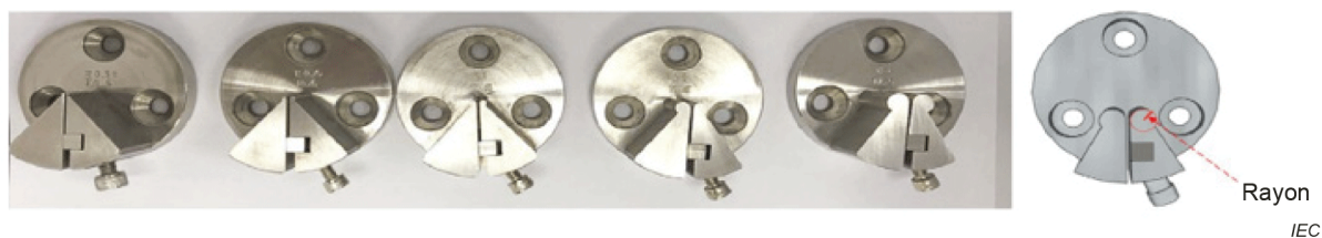
Figure 5 – Gabarits de pliage de flexibilité (avec de la gauche vers la droite des rayons de pliage r de 1,0 mm, 2,0 mm, 3,0 mm, 4,0 mm, 5,0 mm et 10,0 mm)
