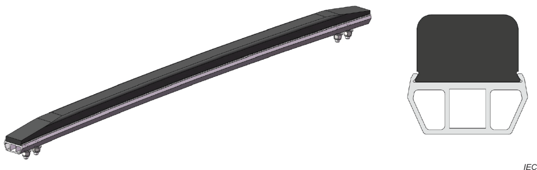
Figure 1 – Exemple de bande de frottement autoportée
