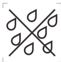
Figure 6 – Lampe inappropriée à une utilisation dans un environnement humide
