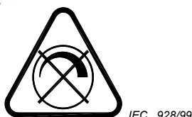
Figure 1 – Utilisation avec un gradateur interdite
