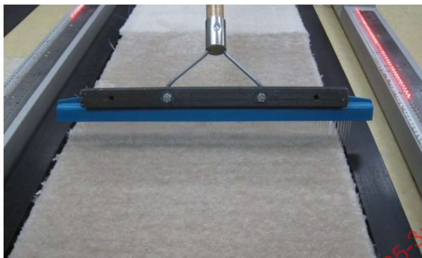
Figure 2 – Outil de cardage des tapis lesté
