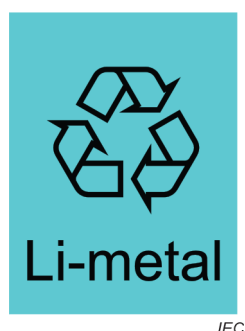
Figure 10 – Exemple de marquage des batteries métal lithium avec symbole de recyclage
