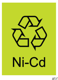
Figure 7 – Exemple de marquage des batteries nickel-cadmium avec symbole de recyclage
