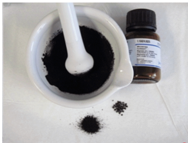
Figure 3 – Gros grains de Nigrosine moulus dans un mortier chimique
