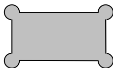
Figure 11 – Dépouille d'angle dans la cavité d'un plateau pour puces
