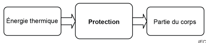
Figure 39 – Modèle de protections contre les brûlures thermiques
