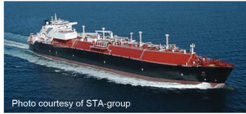
g) LNG carrier prismatic extended deck
