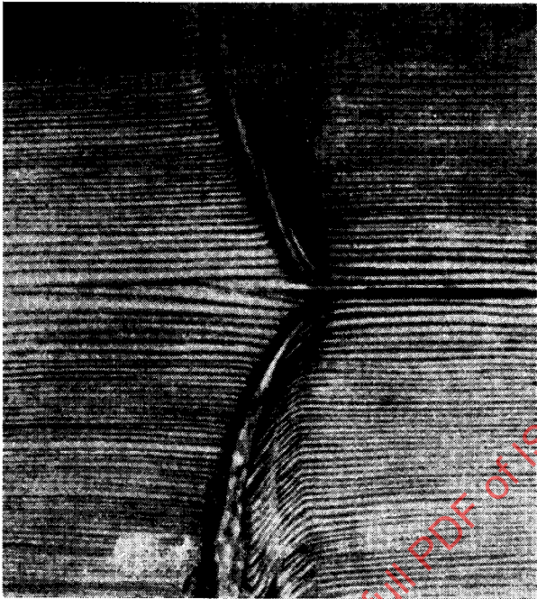
FIG. 5 — Branched knot (spruce) FIG. 5 — Neud double (moustache) (épicéa) Рис. 5 — Разветвленный (лапчатый) сучок (ель)
